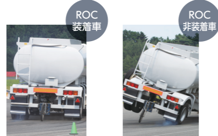
実験は35～45キロ超の進入速度でJターン路に進入。実験のため補助輪が取付されています。
